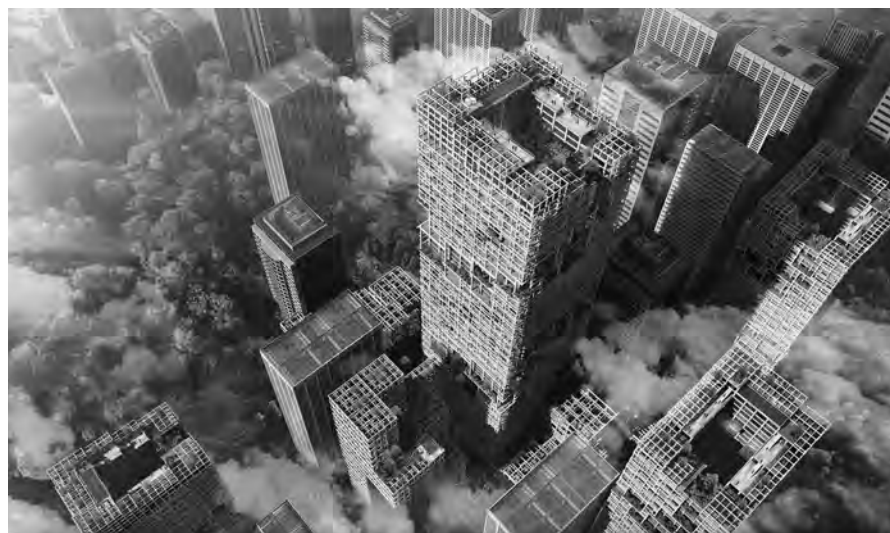
●木材比率9割の木鋼ハイブリッド構造により、高さ350mの木造超高層建築を開発する構想の「W350計画」(画像提供:住友林業・日建設計)
